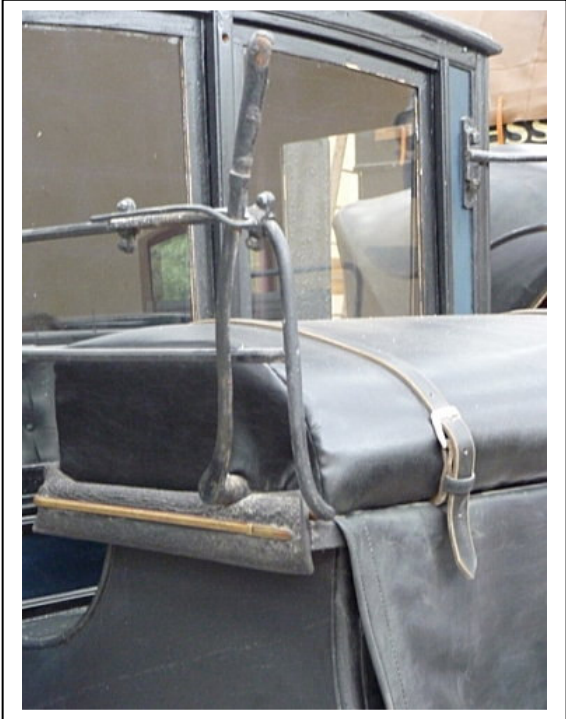
De remhendel dreef een stang aan die verbonden was met de trommelrem
